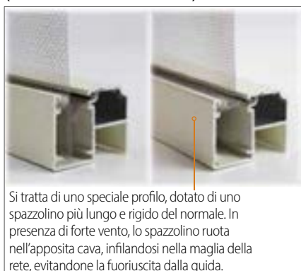
Guida con sistema antivento (brevetto internazionale Bettio)
