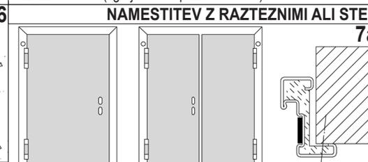
Izvržite izvrtino skozi okvir vrat v točkah, ki so označene na sliki (o). Pritrdite jih z vijaki in plastičnimi vložki Ø8x40mm ali s T.C. vijaki za stene Ø7,5mm. Vijaki in vložki niso dobavljeni.
