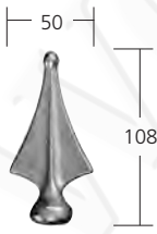
∅ 12,5 foro Bohrung hole
