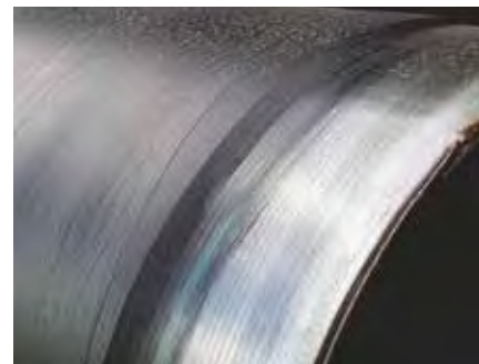
Testata dopo il trattamento di spazzolatura / Pipe chamfer properly brushed
