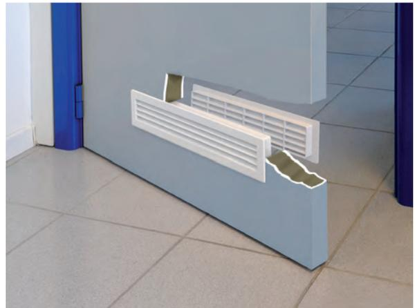
**Griglia P/Telescopica** - Griglia per porte e pannelli. Per il fissaggio occorre accoppiare le due griglie ed avvitarle con le viti in dotazione fino alla misura desiderata. Si evita così di praticare fori per le viti nella porta.
