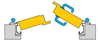
**DEFINIZIONE MISURA PORTA DA SEZIONE LONGITUDINALE**
