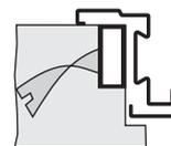
CONTROTELAIO A MURARE SU TELAIO AD AVVITARE
