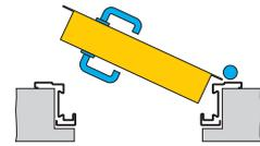
**DEFINIZIONE MISURA PORTA DA SEZIONE LONGITUDINALE**
