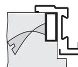
CONTROTELAIO A MURARE SU TELAIO AD AVVITARE
