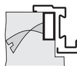
CONTROTELAIO A MURARE SU TELAIO AD AVVITARE
