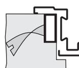
CONTROTELAIO A MURARE SU TELAIO AD AVVITARE
