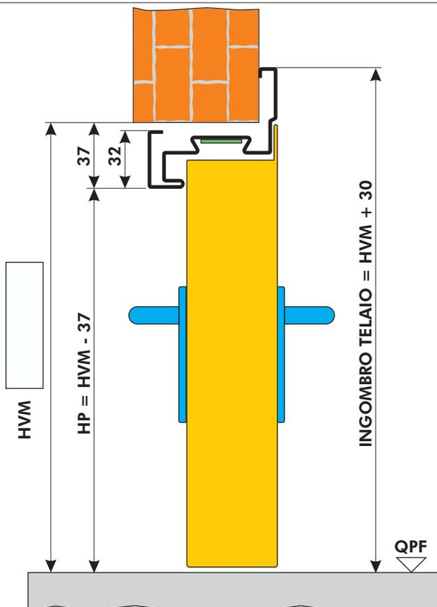
**TIPOLOGIE DI FISSAGGIO**
