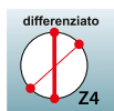
Quattro taglienti Z4 con passo differenziato dell'elica Four tooth with differential pitch cutters
