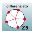
Cinque taglienti Z5 con passo differenziato dell'elica Five tooth with differential pitch cutters
